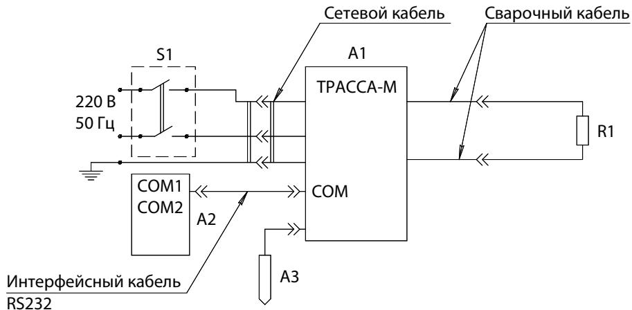
A1 – сварочный аппарат «ТРАССА-М» ОСО 5–01;
